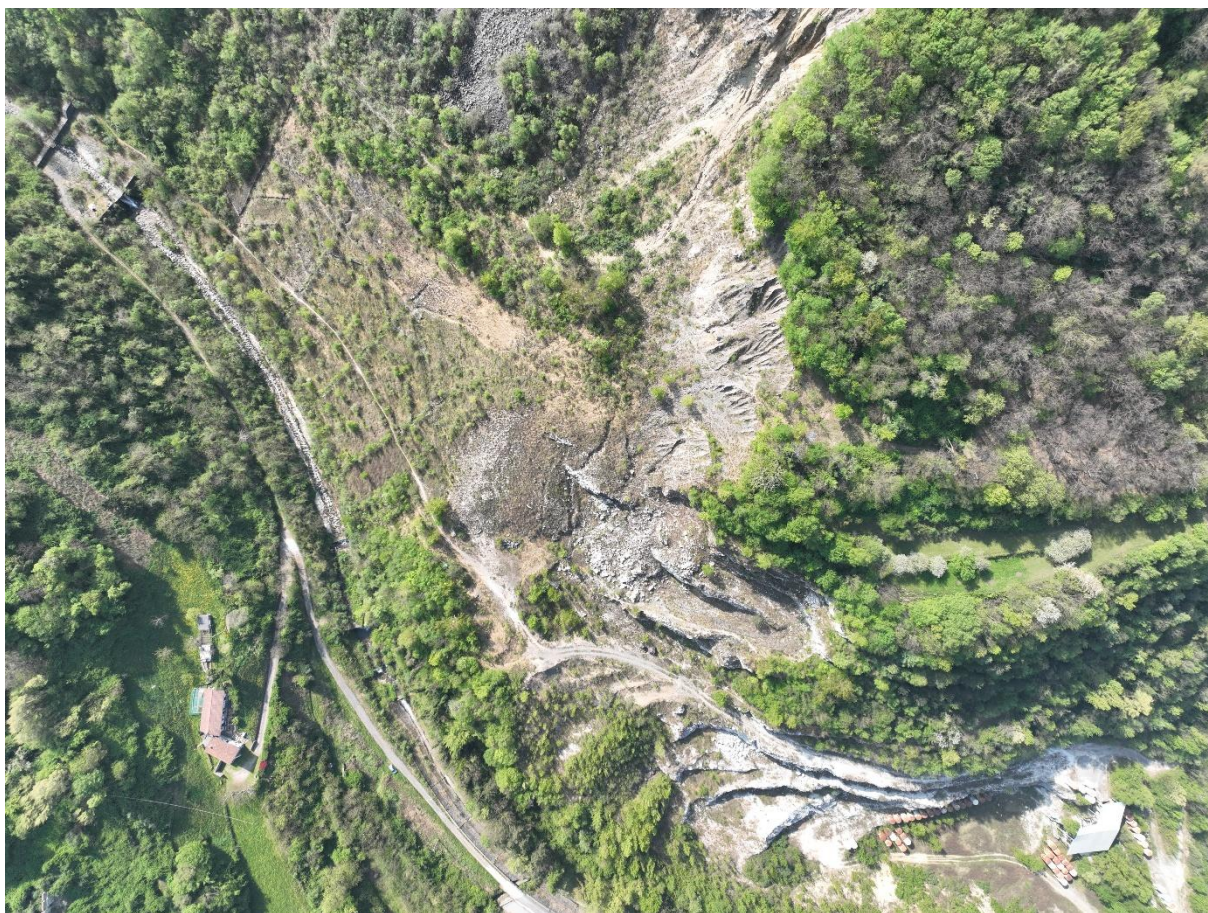
Vista della porzione a valle e in sinistra dell'area in frana; sulla sinistra dell'immagine si vede il corso del T. Trobiolo; in destra si notano le bancate di cava dismesse.
